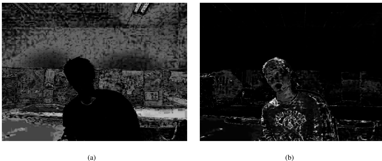
图 4.5 背景和前景数据项。(a) 背景数据项，像素颜色越亮，属于背景的概率越高；(b) 前景数据项，像素颜色越亮，属于前景的概率越高。
