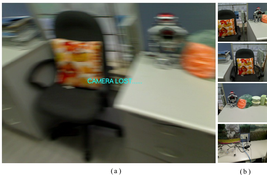
图 3.13 三维跟踪失败的情形。(a) 输入图像；(b) 识别的候选关键帧。因为输入图像的外观由于运动模糊发生了很大的变化，无法正常匹配特征点，也就不能求解摄像机参数。
