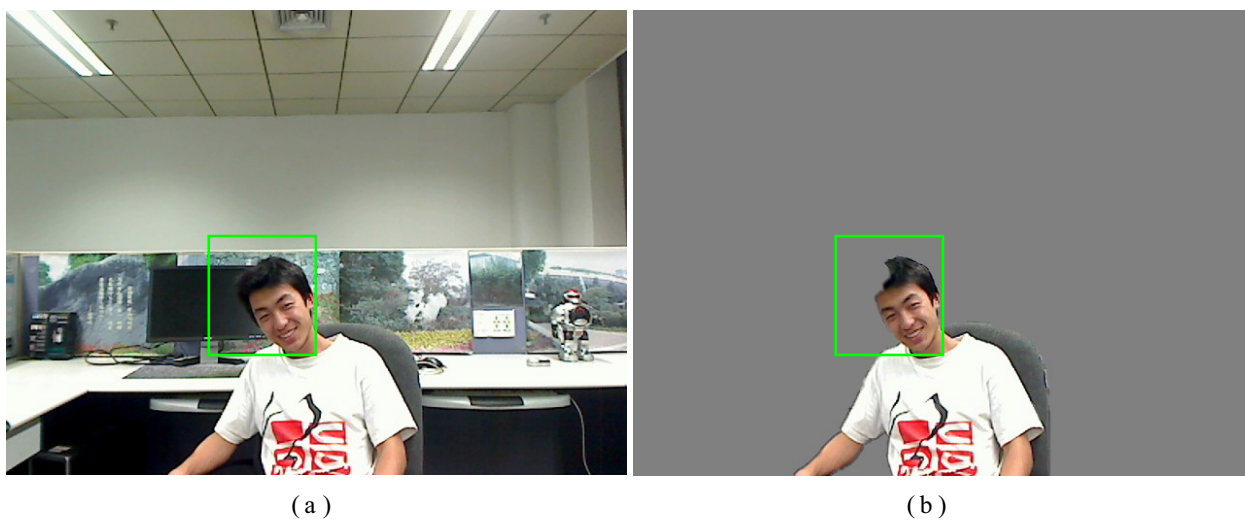
图 4.12 双层分割错误。(a) 输入图像；(b) 前景物体。如绿色方框包围的区域，由于头发的颜色和显示器的颜色都是黑色，头发的边缘信息又很弱，本文的算法无法区分二者的颜色，导致分割错误。
