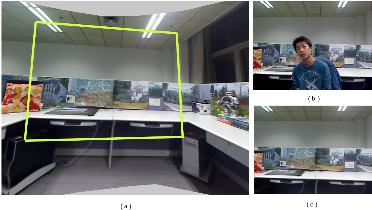
图 4.2 背景全景图创建和实时配准。(a) 背景全景图；(b) 输入图像；(c) 配准估计的背景图像。背景全景图上的黄色四边形所包围的区域是输入图像对应的背景，需要经过单应矩阵映射成当前视角的背景图像。
