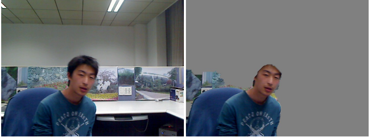
图 4.3 高斯混合模型的分割结果。因为背景的颜色分布非常复杂，而且含有与前景相近的颜色，经典的高斯混合模型并不适用。
