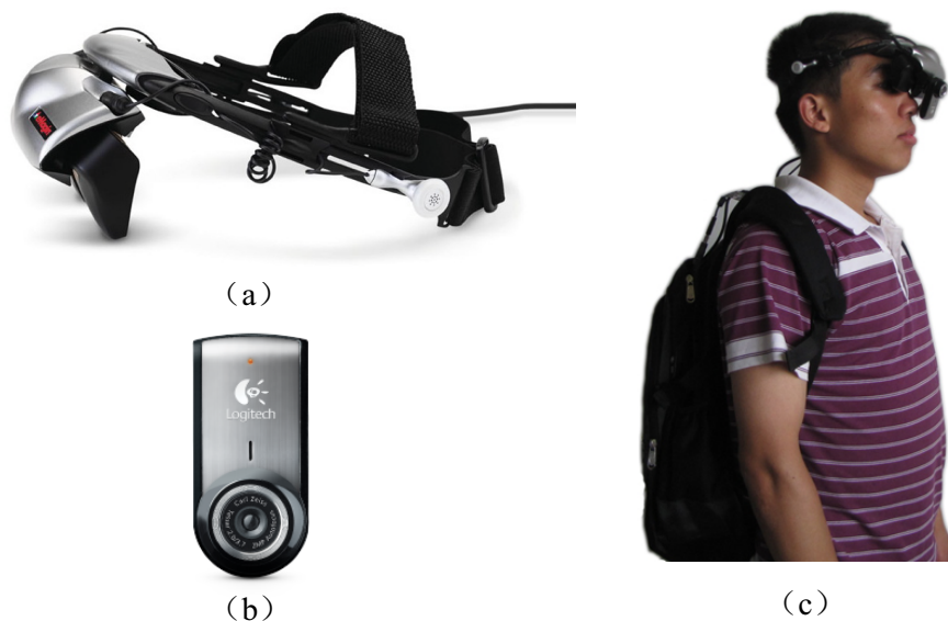
图 4.13 移动摄像头和头盔显示器。(a) 头盔显示器 eMagin Z800 3DVisor; (b) 罗技高清摄像头C905; (c) 用户携带头盔显示器、摄像头、和笔记本。
