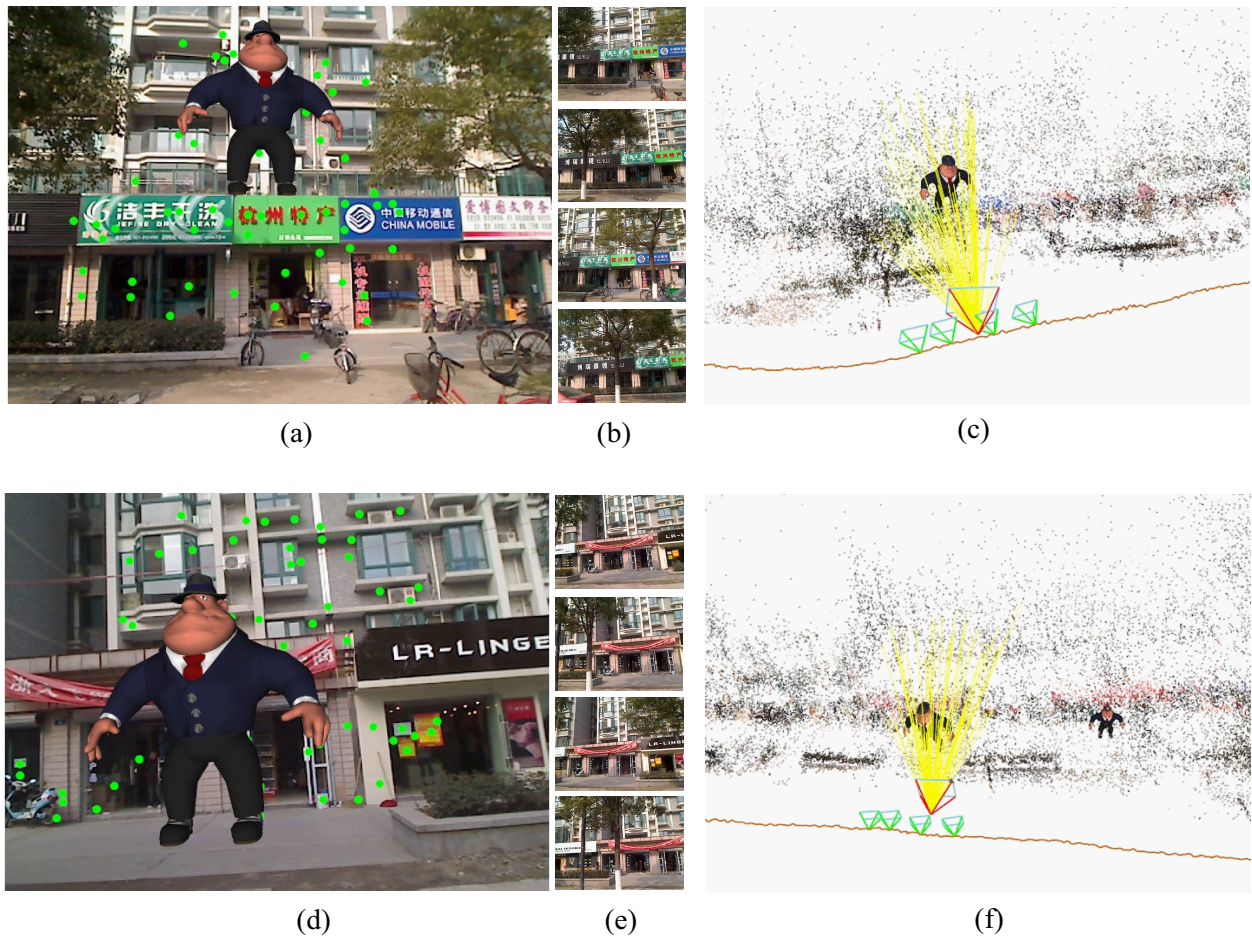
图 3.11 Street实例的实时三维跟踪结果。(a) 输入图像的增强现实结果；(b) 图像(a)的候选关键帧；(c) 在三维视图中查看跟踪结果；(d-f) 另一帧输入图像的增强现实结果和三维视图。
