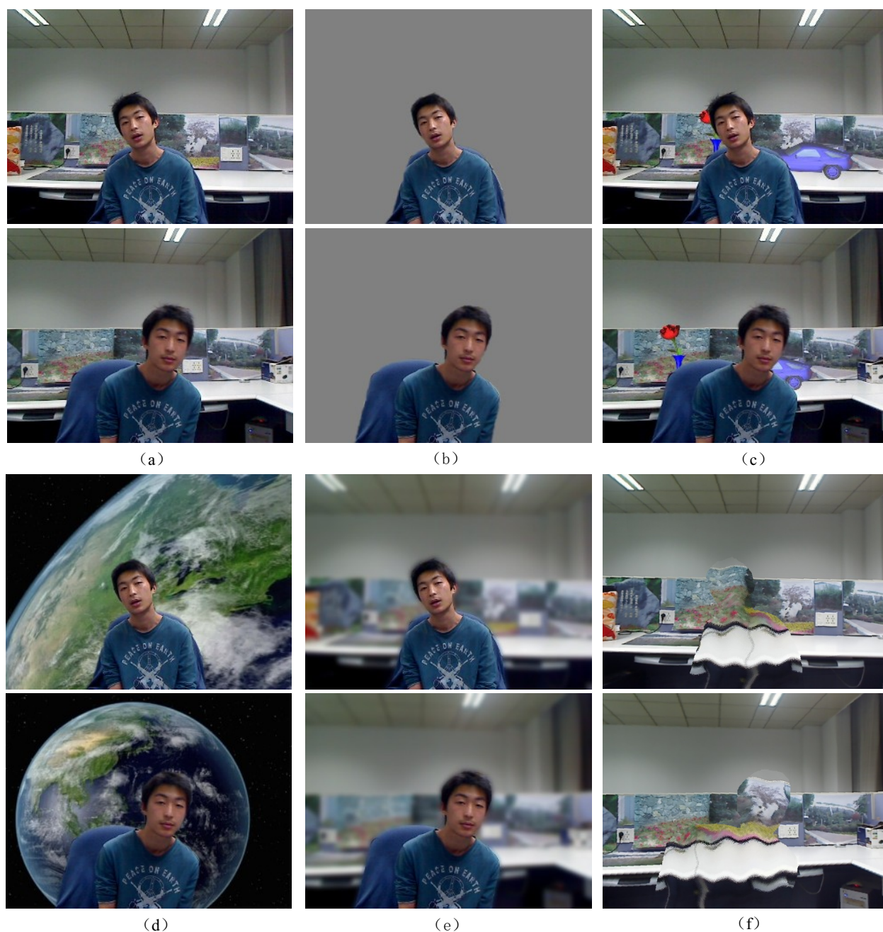
图 4.9 Cubicle实例的增强现实结果。(a) 两帧输入图像；(b) 分割的前景物体；(c) 增强现实加入虚拟物体的遮挡效果；(d) 动态背景替换；(e) 模糊背景模拟景深效果；(f) 前景隐形。
