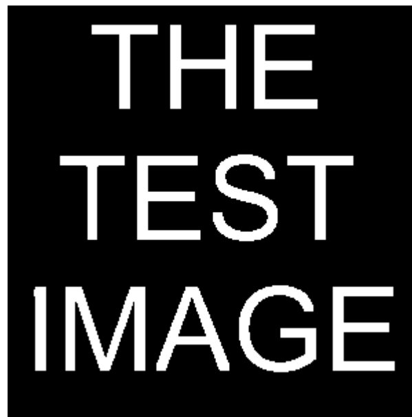
腐蚀两次，然后膨胀两次（开操作）
