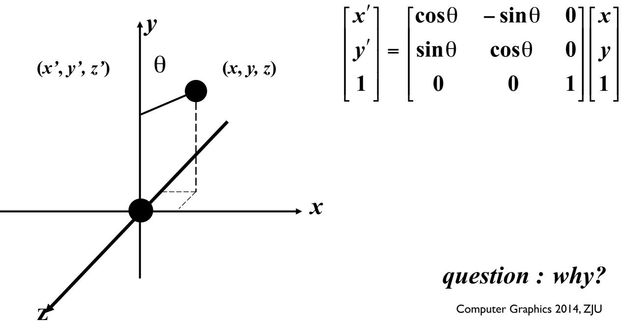
$$\begin{bmatrix} x' \\ y' \\ 1 \end{bmatrix} = \begin{bmatrix} \cos \theta & -\sin \theta & 0 \\ \sin \theta & \cos \theta & 0 \\ 0 & 0 & 1 \end{bmatrix} \begin{bmatrix} x \\ y \\ 1 \end{bmatrix}$$
