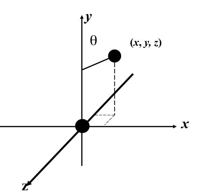
$$\begin{bmatrix} x' \\ y' \\ 1 \end{bmatrix} = \begin{bmatrix} \cos \theta & -\sin \theta & 0 \\ \sin \theta & \cos \theta & 0 \\ 0 & 0 & 1 \end{bmatrix} \begin{bmatrix} x \\ y \\ 1 \end{bmatrix}$$
