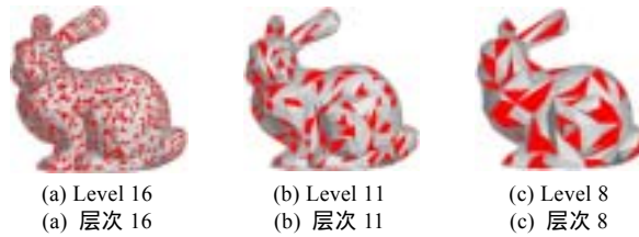
Fig.7 The distribution of the collapsed triangles 图 7 折叠三角形的分布
