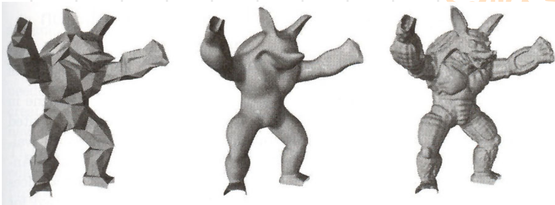
图12.55 左边是初始网格，中间是使用Loop细分方法得到的曲面，右边是偏移细分曲面
