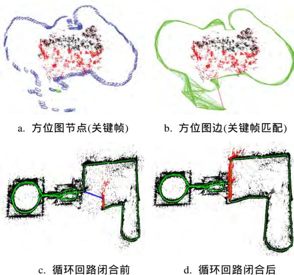
图 4 ORB-SLAM 的方位图优化和循环回路闭合<sup>[26]</sup>
