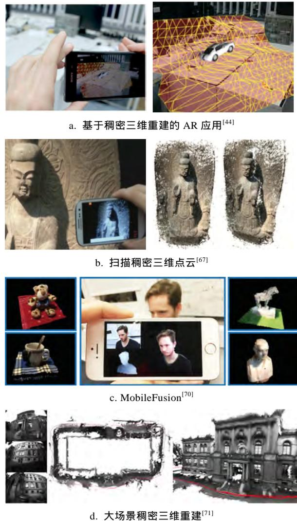
图 8 基于单目摄像头的稠密三维重建
